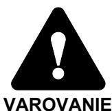
Vždy umiestnite prídavné zariadenie do bezpečnej polohy predtým, než sa k nemu priblížite. Bezpečná poloha zabráni neúmyselným pohybom prídavného zariadenia a ramena nakladača. Uvedomte si, že prídavné zariadenie sa môže pohnúť, aj keď je motor nakladača vypnutý. Proces bezpečného zastavenia:
